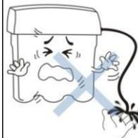
Wenn die Abwasserleitung abknickt/blockiert, staut sich das Abwasser im Gerät und kann zu Schäden an Membrane und sogar zu Wasserschäden führen.
