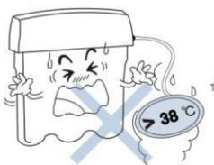
Wasser mit über 38°C Temperatur schädigt die Umkehrosiose-Membrane nachhaltig und führt zum Defekt der Anlage.
